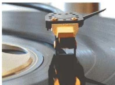
Не снимая защитное приспособление иглы, разместите пластинку на опорном диске, а тонарм таким образом, чтобы игла находилась прямо над выводной канавкой. Отрегулируйте высоту The Q UP таким образом, чтобы ПОДЪЕМНОЕ УСТРОЙСТВО ТОНАРМА не касалось самого тонарма, зазор должен быть около 1,5 мм.
