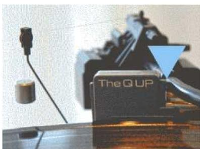
Отрегулируйте горизонтальное положение The Q UP таким образом, чтобы триггер слегка касался тонарма.
