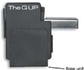
В нижней части основания находится липкая полоса — специально для размещения подъемного устройства. Основание отделено от подъемного устройства и позволяет ему перемещаться горизонтально для точной настройки положения триггера и вертикально — поскольку у разных моделей тонармов разная высота.
