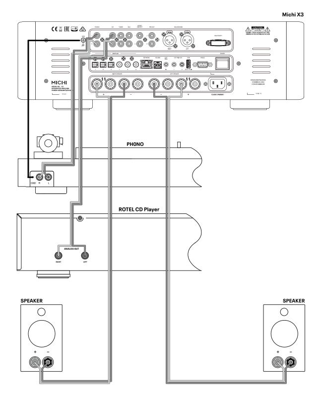
Figure 4: Digital Input and 12 Volt Trigger Out Connections Entrées numériques et Branchements des sorties trigger 12 V Anschlussdiagramm (Digitaleingänge, 12V-Trigger-Ausgänge) Entrada Digital y Conexiones de Salida para Señal de Disparo de 12 Voltios Digitale ingangen en 12V-triggeruitgangen Collegamenti ingressi digitali e segnali Trigger 12 V Anslutningar för digitala ingångar och 12-volts styrsignaler Цифровой вход и выход 12-В триггерного сигнала
